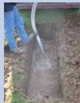
Remplissage d'une fouille pour essai d'infiltration
