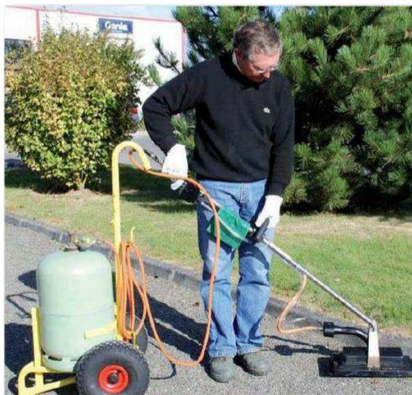
Désherbeur thermique infrarouge modèle Eco sur chariot (Cornu)
