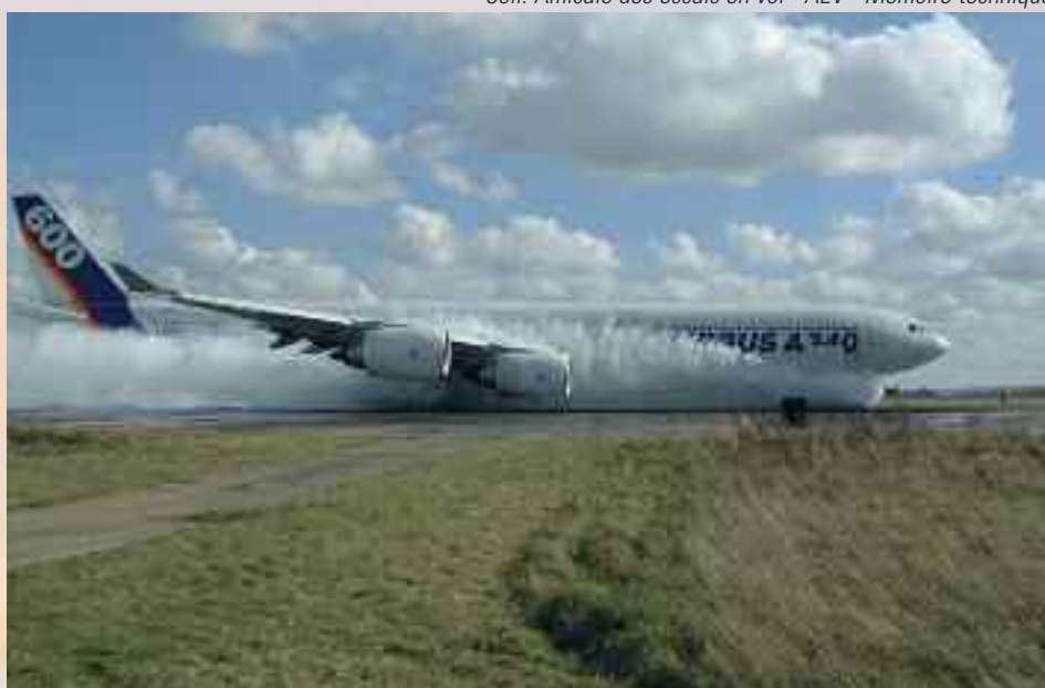
Essais de l'Airbus A340-600 sur piste d'envol avec passage en piscine, 2001. Coll. Amicale des essais en vol - AEV - Mémoire technique
