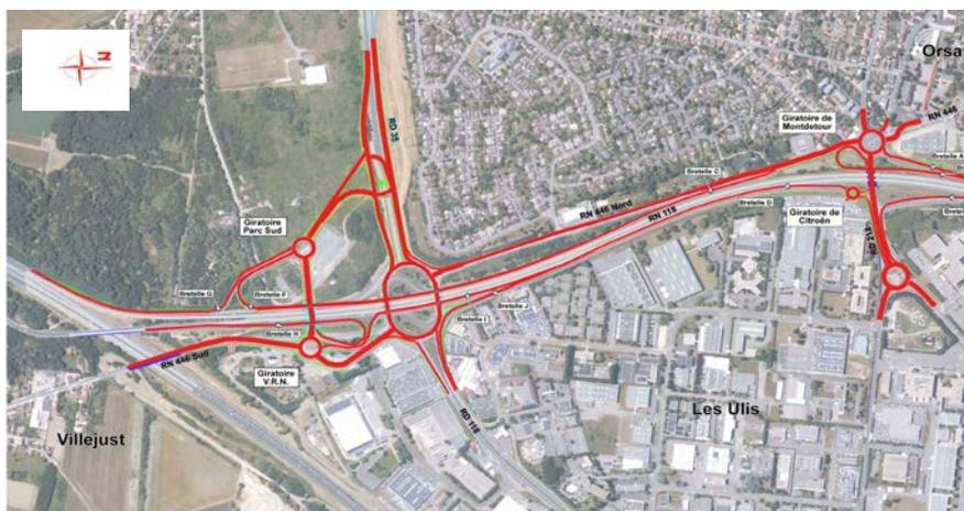
Les bretelles d'accès intérieures à l'anneau seront démolies, supprimant les échanges directs avec la RN 118. Un échangeur « à lunettes » permettant tous les mouvements sera aménagé au sud du Ring (entre le Ring et l'A 10).
